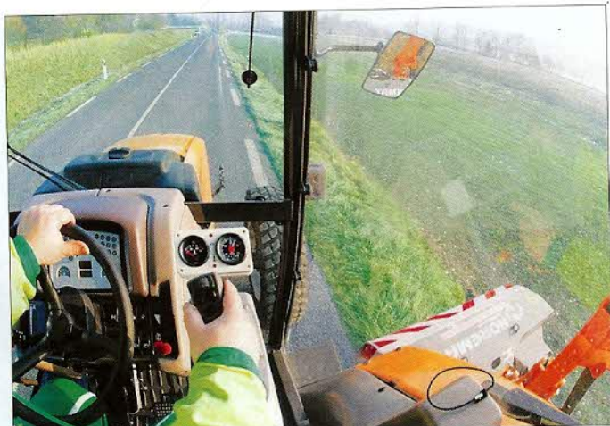
Díky předsunutí ramene má obsluha dokonalý přehled o práci adaptéru
