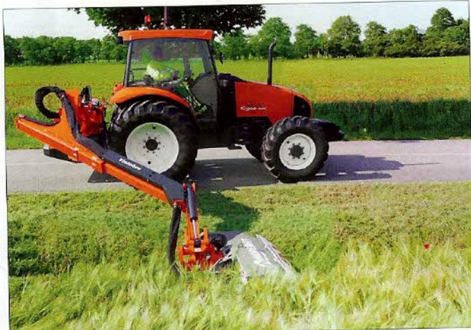
Model příkopového ramene Noremat Magistra Visio M61T s předsunutým ramenem
